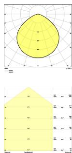
Scheda tecnica Ledvance Highbay LED Sensor Gen4 87W 13000lm 110D - 840 Bianco Freddo | IP65 - Sensore di movimento e luce
